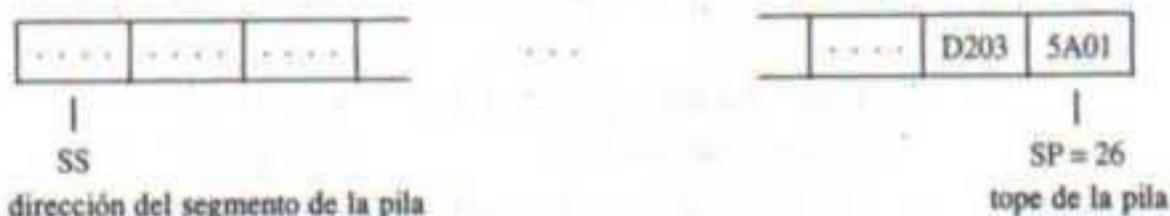
5. POP AX: regresa la palabra que se encuentra en la pila, en donde apunta el SP, y la envía al registro AX e incrementa el SP en 2 (a 28H). El AX ahora contiene 015AH, con los bytes correctamente invertidos:
