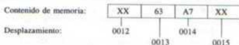
En este caso, el procesador tiene que realizar *dos* accesos. Primero, accesa los bytes en 0012H y 0013H y envía el byte de 0013H (63) al registro AL. Después accesa los bytes en 0014H y 0015H y envía el byte de 0014H (A7) al registro AH. Ahora el AX contiene A763H.
