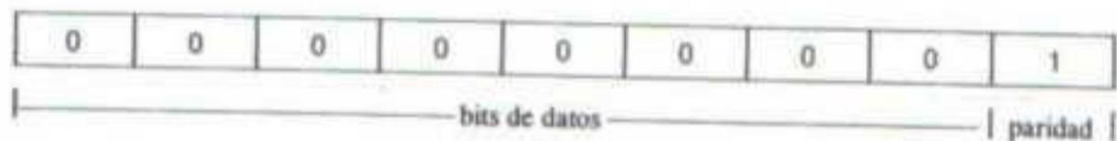
Los ocho bits de datos proporcionan la base para la aritmética binaria y para representar caracteres como la letra A o el símbolo de asterisco (\*). Ocho bits permiten 256 combinaciones diferentes de condiciones de apagado-encendido (off-on), desde todos los bits apagados (00000000) hasta todos los bits encendidos (11111111). Por ejemplo, una representación de los bits para la letra A es 01000001 y para el asterisco es 00101010, aunque no tenemos que memorizarlas.
