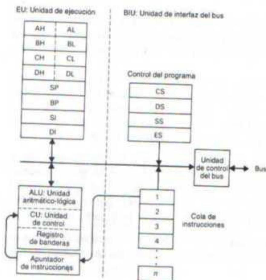
**Figura 1-2** Unidad de ejecución y unidad de interfaz del bus
