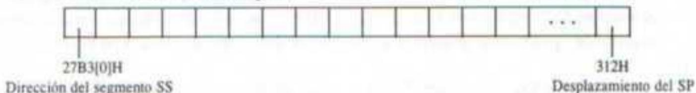
**Registro BP.** El BP de 16 bits facilita la referencia de parámetros, los cuales son datos y direcciones transmitidos vía la pila. Los procesadores 80386 y posteriores tienen un BP ampliado de 32 bits llamado el registro EBP.
