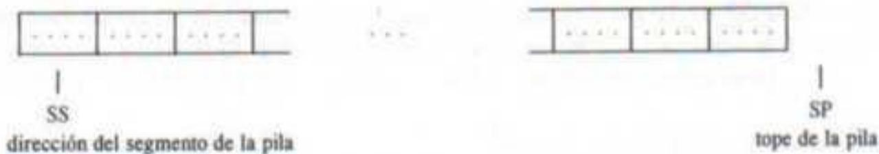
La instrucción PUSH (entre otras) disminuye el SP en 2 hacia abajo, hacia la siguiente palabra almacenada de la pila y coloca (o empuja, *push*) un valor ahí. La instrucción POP (entre otras) regresa el valor de la pila e incrementa el SP en 2 hacia arriba, hacia la siguiente palabra almacenada.
