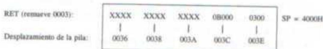
Si utiliza DEBUG para ver la pila, puede encontrar datos irrelevantes a la izquierda de un programa previamente ejecutado.
