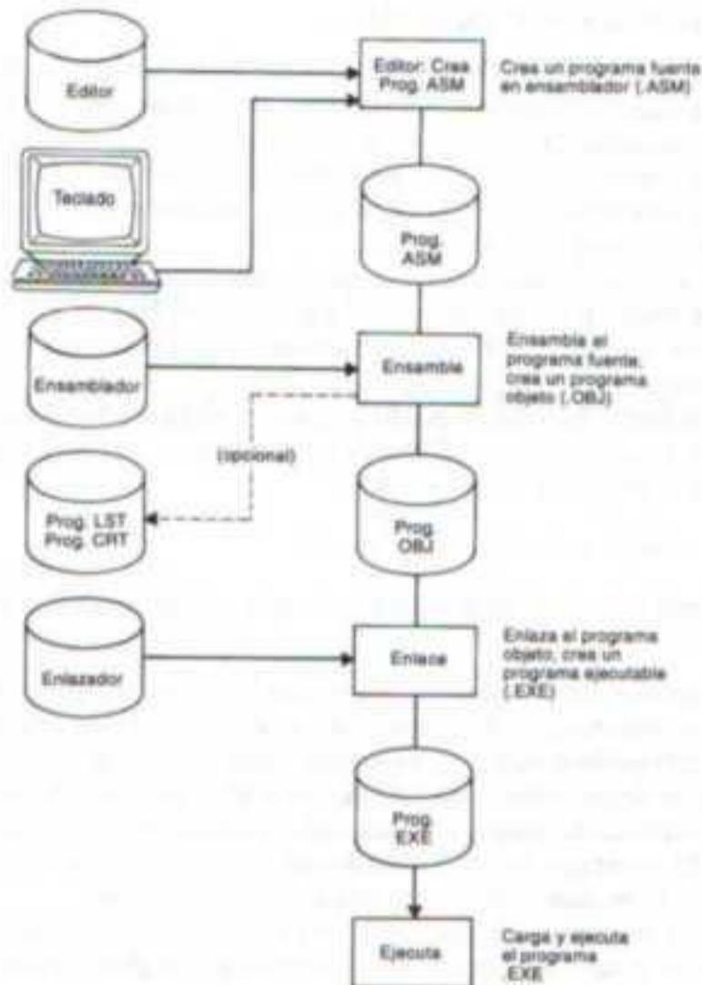
Figura 5-1 Pasos para ensamblar, enlazar y ejecutar
