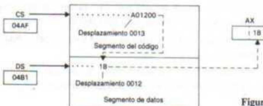
Figura 2-3 Segmentos y desplazamientos
