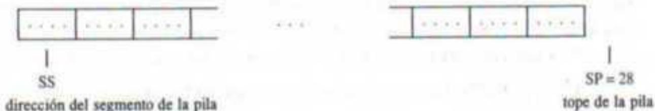
2. PUSH AX: disminuye el SP en 2 (a 26H) y almacena el contenido del AX, 015AH, en la pila. Observe que la operación invierte la secuencia de bytes almacenados, de modo que 015A se convierte en 5A01:
